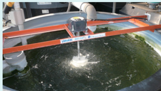
●排水処理水槽：期間を決め、回転数の違いによる藻の発生状況を実験している。
