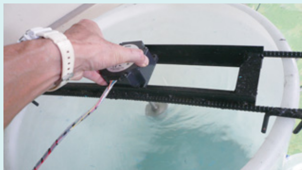
●200リットルの水もこの大きさのモーターで攪拌できる。モーターとステータは固定されず、乗せてあるだけだ。エムレボの穴を目で追えるくらいの低回転で回しても、水が容器全体を対流したのは驚いた。
