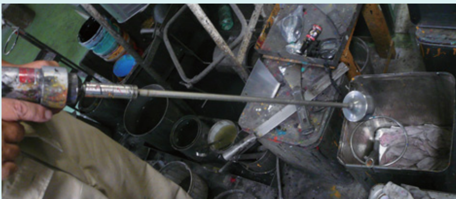
●塗料缶の攪拌はエアードリルの先にエムレボを付け攪拌する。回転の反動が少なく飛び散りもないので、余分な力を使わずに済み短い時間で攪拌できる。
